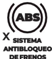
Sistema diseñado para evitar que las ruedas se bloqueen al frenar de forma brusca mientras se circula en línea recta, el sistema regula automáticamente la fuerza de frenado.
