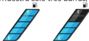
El indicador de combustible muestra una sola barra cuando el combustible alcanza el nivel de reserva (2,2 litros aprox.). el nivel de combustible
