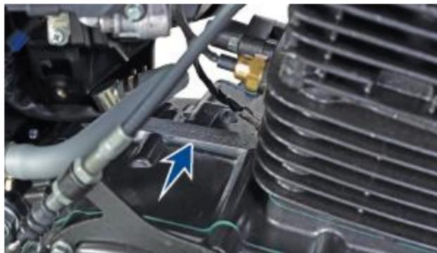
El número de identificación del motor está grabado en la superficie superior del conjunto del cárter del lado izquierdo cerca del bloque de cilindros.
