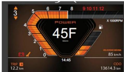
Si el cambio de modo se realiza durante la conducción del vehículo, tanto 'ECO' como 'PWR' parpadearán con mayor frecuencia para indicar que se debe cerrar el acelerador. Si la apertura del acelerador está por debajo del valor predefinido, el parpadeo se detendrá o continuará durante 25 segundos y el vehículo pasará al modo de conducción anterior.
