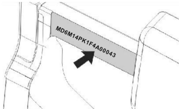
El número de VIN está ubicado cerca al espaldar del conductor, al costado derecho del Vehículo.
