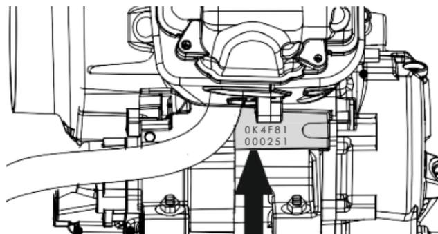
El número de motor está ubicado en el cárter derecho del motor, cerca a los soportes traseros.
