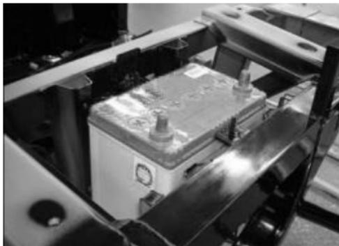
3. Si el nivel de electrolito está bajo el MIN adicione solo agua destilada hasta el MAX retirando los tapones de llenado
