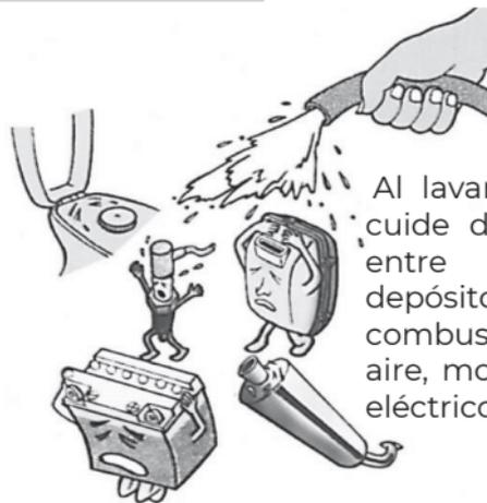
Al lavar el Vehículo cuide de que no le entre agua al depósito de combustible, filtro de aire, mofle y sistema eléctrico.
