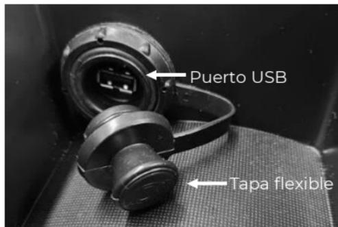
El cargador está diseñado para ser usado fácilmente, se encuentra debajo del sillín. Se recomienda solo sea usado cuando la motocicleta esté encendida ya que la entrega de corriente no está condicionada a que el motor esté en marcha y su uso prolongado con la motocicleta apagada podría descargar su batería y causar una avería irreparable.
