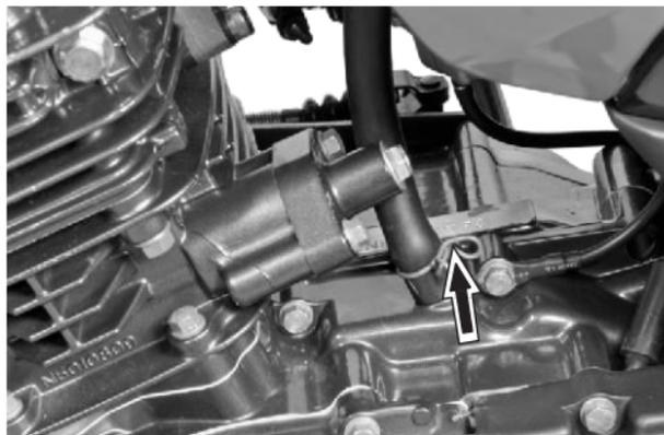
El número de motor está ubicado en la parte superior de la carcasa izquierda del motor.
