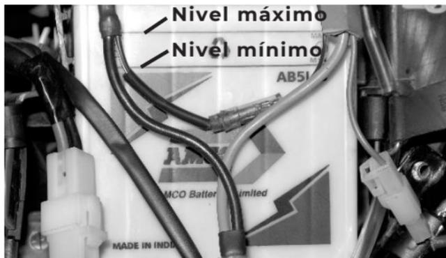
3. Si el nivel de electrolito está bajo el MIN adicione solo agua destilada hasta el MAX retirando los tapones de llenado
