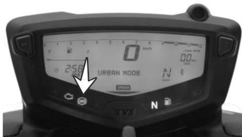
El testigo de ABS se apaga una vez el Vehículo alcanza 6 km/h o superior y se ilumina cada que la velocidad del Vehículo sea inferior a 6 km/h, indicando que el sistema de ABS está funcionando correctamente. Si el testigo de ABS continúa iluminado luego de alcanzar una velocidad mayor a 6 km/h significa que el sistema puede estar presentando algún error.
