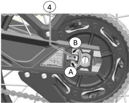
6. Después de completar el ajuste, apriete la tuerca del eje trasero, aplique un torque de 100-110 Nm
