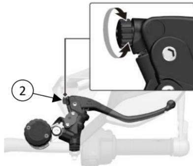
Gire la perilla en el sentido horario para aumentar la distancia entre la leva y el manillar y en el sentido contrario para acercar la leva al manillar. Despu s del ajuste y antes de iniciar la marcha, verifique si la leva de freno funciona correctamente.
