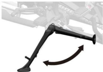
**ADVERTENCIA:** Compruebe que el soporte lateral funciona libremente. Si el soporte lateral está rígido o chirría, limpie la zona del pivot y engrase el tornillo pivot con aceite lubricante. Compruebe si el resorte está dañado o ha perdido elasticidad.
