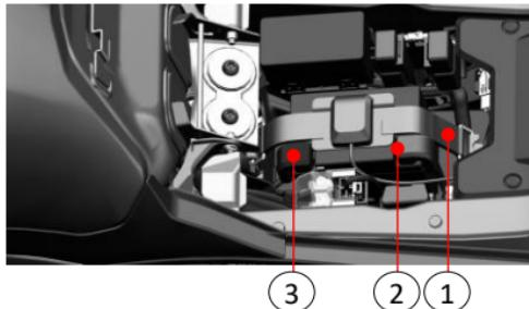
Antes de instalar la batería, compruebe su aspecto. La carcasa exterior debe estar libre de rayaduras y grietas. La tapa de la batería debe estar bien sellada y sin fugas. Los terminales no deben estar torcidos ni deformados.
