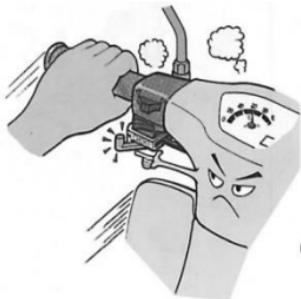
No deje el choke accionado, pues cuando calienta el motor tenderá a apagarse.
