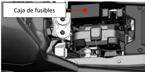
Los fusibles y fusibles de repuesto se encuentran en la caja de fusibles junto al relé de arranque: fusible LCM, fusible ECM, fusible de la alimentación normal, fusible del motor del ABS, fusible de la ECU del ABS, fusible de la bomba de gasolina, fusible de arranque, fusible del ABS, fusible auxiliar, otros fusibles y cuatro fusibles de repuesto.
