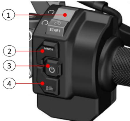
**1. INTERRUPTOR CORTA CORRIENTE:** Sitúe el interruptor en la posición “”, para habilitar el circuito eléctrico pudiendo arrancar el motor. Si coloca el interruptor en la posición “”, el circuito eléctrico se desconectará y no podrá arrancar el motor. En caso de emergencia utilice este interruptor. Presione este botón a la posición “” para poner en marcha el motor.
