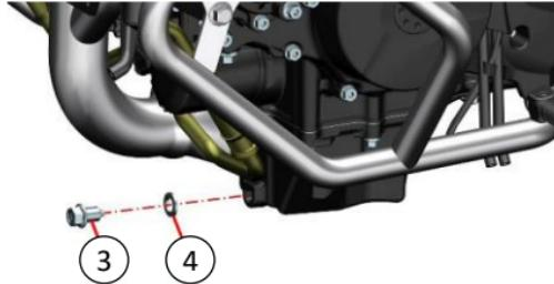
**NOTA:** No arranque ni haga funcionar el motor durante el proceso de drenaje ya que se debe asegurar siempre que haya aceite antes de arrancar el motor.
