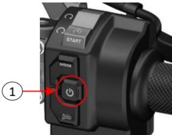
**ATENCIÓN:** Si el manubrio del Vehículo no se desbloquea automáticamente, puede ser porque el manillar está presionando el eje del bloqueo. Ayude a desbloquearlo girando suavemente el manubrio para permitir que el eje del bloqueo se mueva libremente. Si no lo consigue puede que la batería del Vehículo tenga poca carga. Compruebe la carga de la batería.
