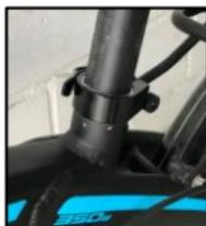
4. Tire del seguro de pliegue de la torre de dirección y pliéguela por completo.
