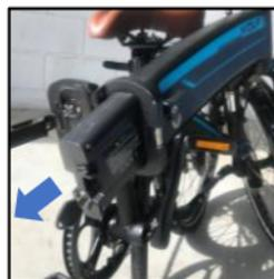
Almacene la batería en la condición de carga completa, y realice el proceso de carga regularmente si no la usará durante mucho tiempo.
