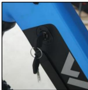
Inserte la llave y gírela en el sentido de las manecillas del reloj hasta la posición OPEN para desbloquear la batería.
