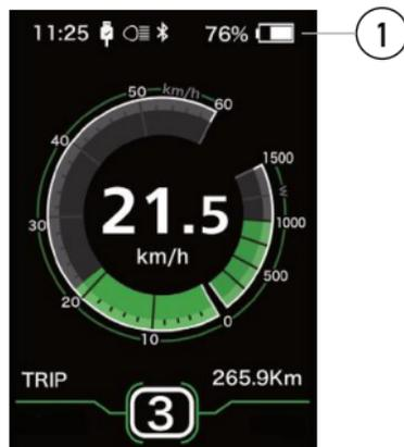
No agote la batería hasta su carga mínima permitida, cuando el indicador de carga del tablero y de la batería esté en el nivel mínimo de batería (barra roja) cargue inmediatamente.
