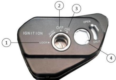
**LOCK (1):** Para bloquear la dirección, gire el manubrio completamente hacia la derecha o la izquierda, presione la llave y gírela hasta la posición "Lock". Se bloqueará la dirección y se aislará el sistema eléctrico.
