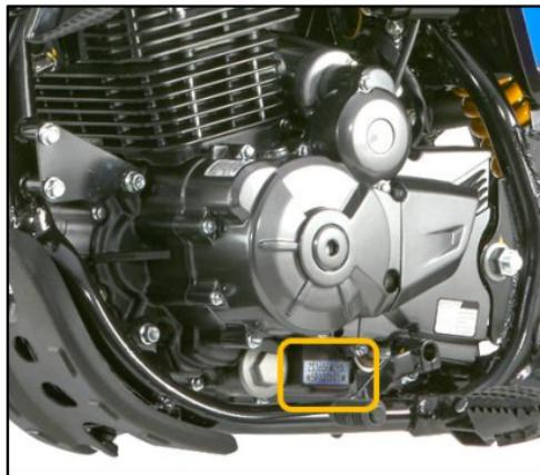
El número del motor se encuentra en la carcasa izquierda del motor en la parte inferior.
