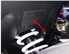
Fig. 4 – Ubicación del controlador
