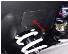
Fig. 4 – Ubicación del controlador
