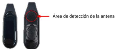
El control remoto KEYLESS cuenta con dos luces LED, una de color verde y otra de color rojo. Cuando la pila del control remoto es suficiente y controlador esté encendido, la luz verde parpadea cada 3 segundos. Cuando la pila tiene poca energía, parpadeará en rojo. La pila tienen una vida útil de seis meses a un año. Si su control KEYLESS pierde sensibilidad o su indicador parpadea en rojo, considere reemplazar la pila. La pila requerida para este control remoto es una CR 1225.
