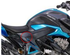
Fig. 4 – Área de inducción no eléctrica
