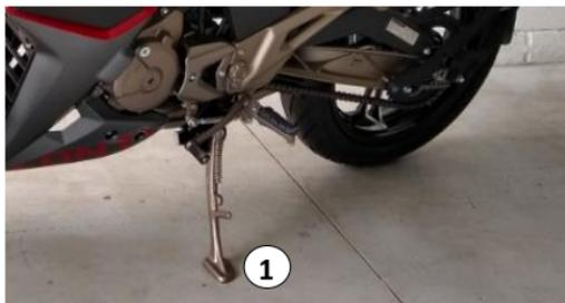
**ADVERTENCIA:** El interruptor del soporte lateral forma parte del circuito que corta el encendido; el usuario debe recoger el soporte lateral antes de iniciar la marcha. Si esta funcionalidad está inactiva, diríjase a un CSA para su reparación.
