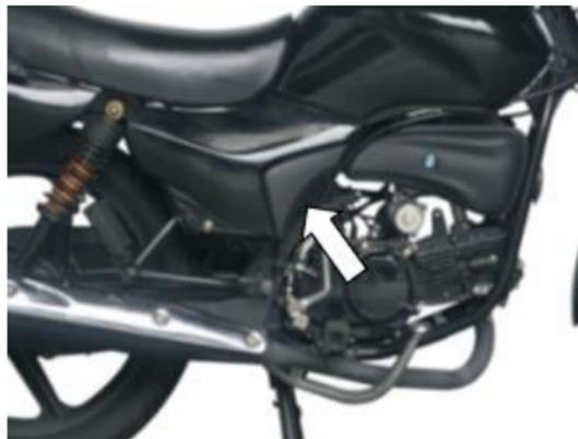
La bujía está al lado derecho del motor, para acceder a la bujía, retire el capuchón y utilice la copa bujía para desatornillarla.
