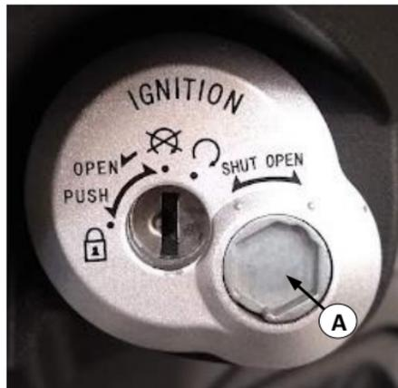
Inserte la parte posterior de la llave en el obturador de seguridad (A) y gire la llave hacia la izquierda para bloquear el suiche de encendido o hacia la izquierda para abrir el obturador y permitir el ingreso de la llave en el suiche.
