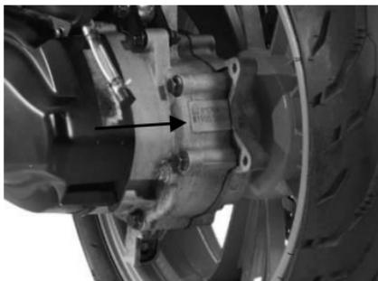
El número del motor se encuentra en la parte trasera de la carcasa izquierda del motor.
