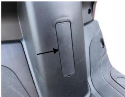
El número del chasis (VIN) está en el chasis en la parte inferior del cabezote de la dirección. Para acceder a este retire la tapa plástica rectangular ubicada en la cubierta que cubre el cabezote de dirección, tal cual como se muestra en el imagen.
