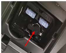
Fig. 2 – Puerto de carga del controlador KEYLESS
