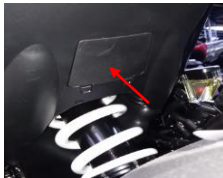
Fig. 4 – Ubicación del controlador
