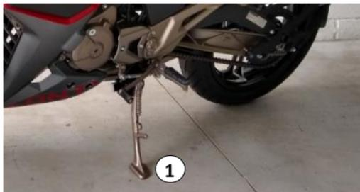
**ADVERTENCIA:** El interruptor del soporte lateral forma parte del circuito que corta el encendido; el usuario debe recoger el soporte lateral antes de iniciar la marcha. Si esta funcionalidad está inactiva, diríjase a un CSA para su reparación.
