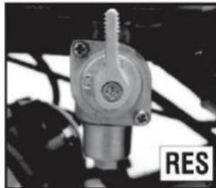
**OFF:** Se interrumpe el suministro de combustible. Coloque el grifo en “OFF” cuando vaya a almacenar el Vehículo o cuando vaya a demostrar el tanque del combustible.
