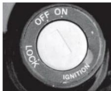
**LOCK:** Para bloquear la dirección, gire el manubrio completamente hacia la derecha o la izquierda, presione la llave y gírela hasta la posición "Lock". Se bloqueará la dirección y se aislará el sistema eléctrico.
