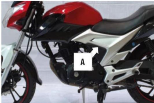
La bujía está al lado derecho del motor, para acceder a la bujía, retire el capuchón y utilice la copa bujía para desatornillarla.
