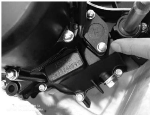
El número del motor se encuentra en el lado izquierdo del motor, debajo de la cubierta del generador.
