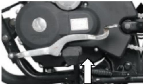
El número del motor se encuentra en el lado izquierdo del motor, debajo de la cubierta del generador.
