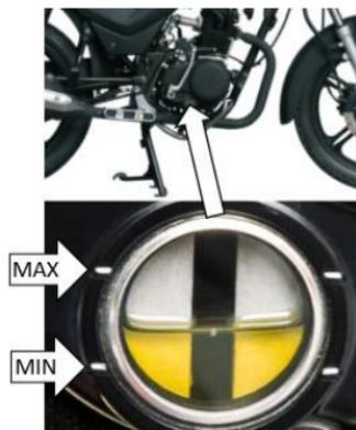
La ventana de verificación de nivel de combustible se encuentra en la cubierta derecha del motor.
