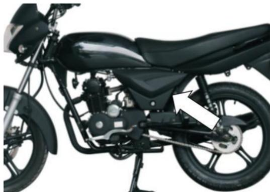
La bujía esta al lado derecho del motor, para acceder a la bujía , retire el capuchón y utilice la copa bujía para desatornillarla.
