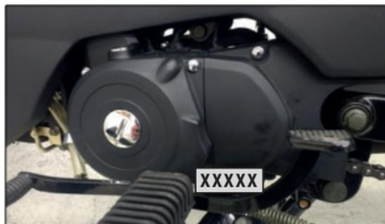
El número de motor está ubicado en la carcasa del lado izquierdo bajo la palanca de cambios.
