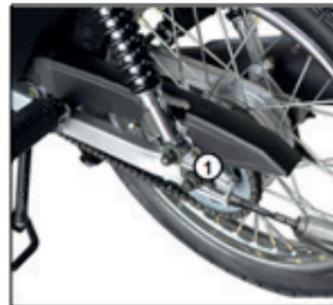
El ajuste de la cadena debe ser realizado siempre que sea requerido (realice constantemente la inspección de esta). La holgura de la cadena debe estar entre 10 – 20 mm. Lubrique la cadena si es necesario.
