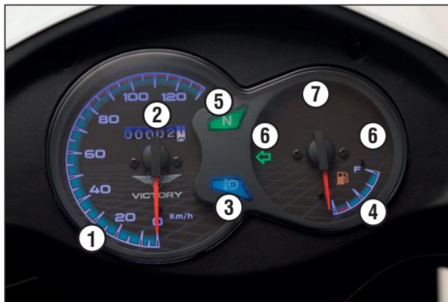
1. Velocímetro: Muestra la velocidad del vehículo.
