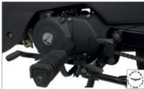
La secuencia para el cambio de velocidades se muestra en la figura. Recuerde que para hacer un cambio de velocidad, debe cerrar el acelerador.
