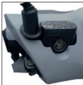
El depósito para el líquido del freno delantero está ubicado al lado derecho del manubrio.
