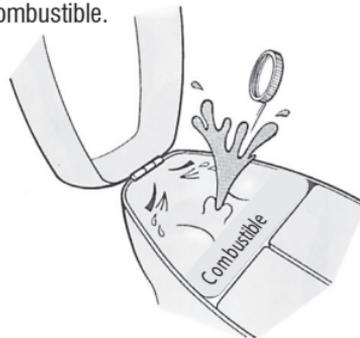
No retire las bujías con el motor caliente.
