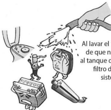
Al lavar el vehículo cuide de que no le entre agua al tanque de combustible, filtro de aire, mofle y sistema eléctrico.
