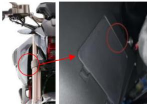
**ATENCIÓN:** Si el manubrio del Vehículo no se desbloquea automáticamente, puede que el cierre en el eje de la dirección se haya atascado. Ayude a desbloquearlo girando suavemente el manubrio para liberar el cierre. Si no lo consigue puede que la batería de la moto tenga poca carga. Compruebe la carga de la batería.
