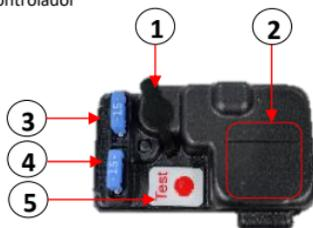
1. Conector de carga de la batería.
