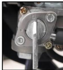
**OFF:** Se interrumpe el suministro de combustible. Coloque el grifo en "OFF" cuando vaya a almacenar el Vehículo o cuando vaya a demostrar el tanque del combustible.
