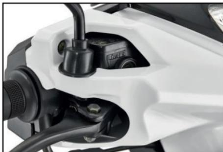
El depósito para el líquido del freno delantero está ubicado al lado derecho del manubrio.
