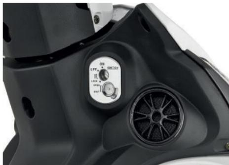
**Llave:** Este vehículo cuenta con 2 ranuras para la llave, una de contacto y la otra de bloqueo. Con la ranura de contacto puede realizar varias funciones como: encendido del vehículo o bloqueo de la dirección. La ranura de bloqueo permite cerrar el paso de la llave hacia la ranura de contacto.
