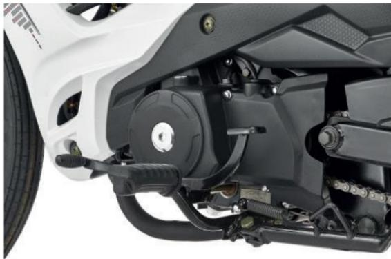
El número del motor se encuentra en la carcasa del motor al lado izquierdo junto al eje de cambios.
