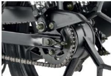
El ajuste de la cadena debe ser realizado siempre que sea requerido (realice constantemente la inspección de esta). La holgura de la cadena debe estar entre 10 – 20 mm. Lubrique la cadena si es necesario.
