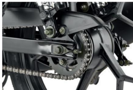
El ajuste de la cadena debe ser realizado siempre que sea requerido (realice constantemente la inspección de esta). La holgura de la cadena debe estar entre 10 – 20 mm. Lubrique la cadena si es necesario.
