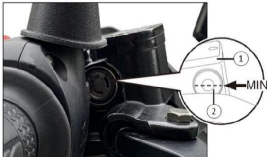
Siempre garantice que el nivel (2) esté por encima de la marca mínima. Use solamente líquido de frenos DOT4.
