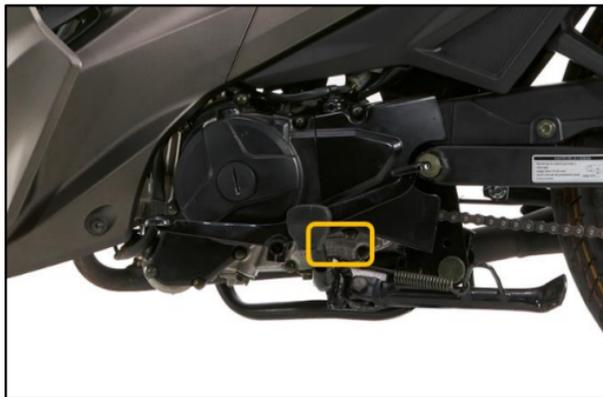
El número del motor se encuentra en la carcasa izquierda del motor en la parte inferior.
