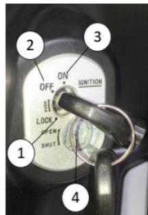
**LOCK (1):** Para bloquear la dirección, gire el manubrio completamente hacia la derecha y gírela la llave hasta la posición "Lock". Se bloqueará la dirección y se aislará el sistema eléctrico.
