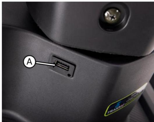
**Nota:** Use el toma de carga USB solamente para la carga de la batería del teléfono móvil, al estar encendido el Vehículo. El uso de otros dispositivos electrónicos puede causar daños en el sistema eléctrico.
