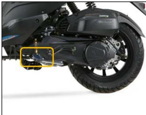
El número del motor se encuentra en la carcasa izquierda del motor en la parte inferior.
