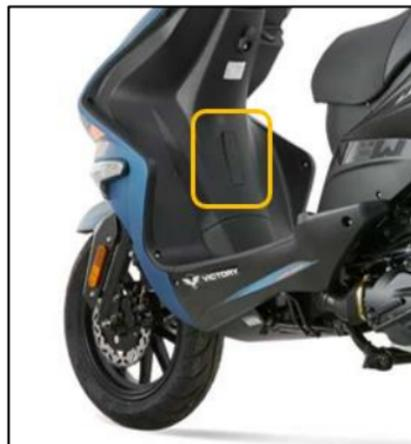
2. El número del chasis (VIN) está en el chasis en la parte frontal del Vehículo que se muestra en la imagen
