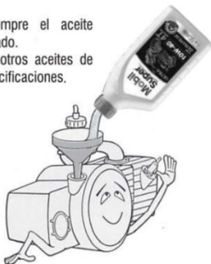
Al drenar el aceite para cambiarlo, el motor debe estar caliente.
