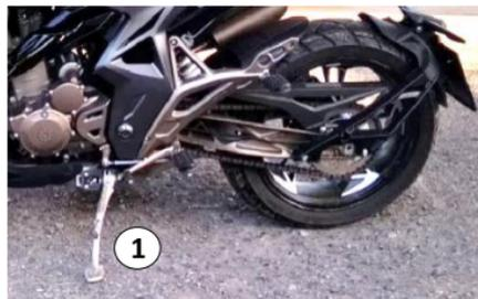
**ADVERTENCIA:** El interruptor del soporte lateral forma parte del circuito que corta el encendido; el usuario debe recoger el soporte lateral antes de iniciar la marcha. Si esta funcionalidad está inactiva, diríjase a un CSA para su reparación.
