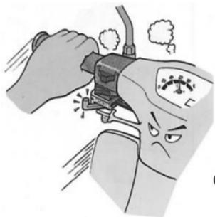
No deje el choke accionado, pues cuando caliente el motor tenderá a apagarse.
