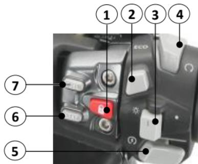
**1. BOTÓN DE ACTIVACIÓN DEL SISTEMA ELÉCTRICO:** Pulse el botón “” para habilitar el sistema eléctrico del Vehículo, el cual, tras detectar la señal de respuesta del control remoto KEYLESS desbloqueará la dirección y permitirá el encendido del motor. Deje presionado el botón “” para apagar y bloquear el Vehículo.
