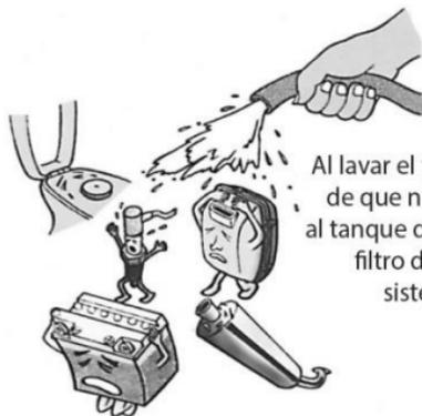
Al lavar el vehículo cuide de que no le entre agua al tanque de combustible, filtro de aire, mofole y sistema eléctrico.
