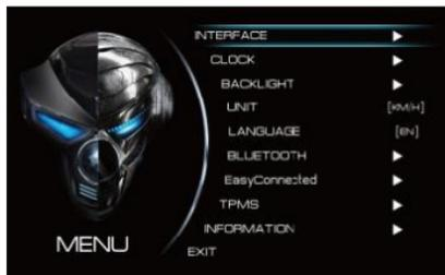
Con el tablero de instrumentos en la interfaz principal, presione el botón "SET" para entrar en el menú principal (Figura 1). Para regresar a la interfaz principal deje presionado el botón "SET" o la pantalla puede volver automáticamente a la interfaz principal si no hay ningún movimiento en 8 segundos.
