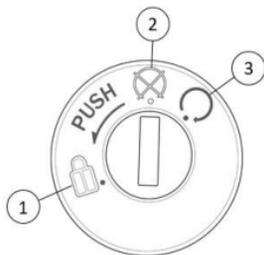
**LOCK (1):** Para bloquear la dirección, gire el manubrio completamente hacia la derecha o la izquierda, presione la llave y gírela hasta la posición "Lock". Se bloqueará la dirección y se aislará el sistema eléctrico.
