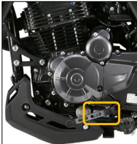
El número del motor se encuentra en la carcasa izquierda del motor en la parte inferior.
