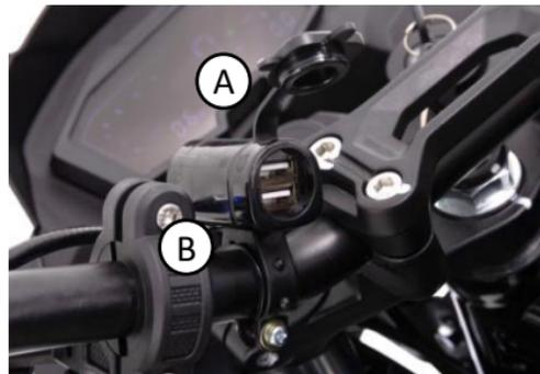
**Nota:** Use el toma de carga USB solamente para la carga de la batería del teléfono móvil, al estar encendido el Vehículo. El uso de otros dispositivos electrónicos puede causar daños en el sistema eléctrico.
