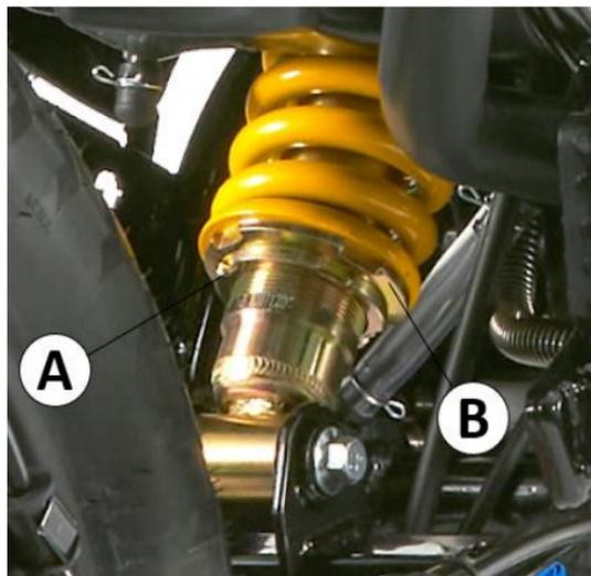
Una vez realizado el ajuste de la precarga del amortiguador, asegúrese de ajustar la contratuerca (A).
