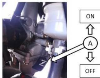
**NOTA:** El choke es una ayuda para facilitar el encendido del motor en condiciones frías, después de estar la motocicleta en la temperatura de funcionamiento ideal, no es necesario accionar el choke.
