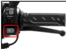
El interruptor de encendido se encuentra el comando derecho del manubrio. Accione la leva del freno delantero o trasero y presione el interruptor para encender el Vehículo.
