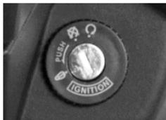
El suiche de encendido se encuentra el comando derecho del manubrio. Accione la leva del freno delantero o trasero y presione el interruptor para encender el Vehículo.
