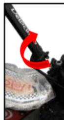
7. Vuelva a insertar el tornillo de la columna de dirección y ajústelo a tope usando la llave mixta de 13 mm y la llave hexagonal de 6 mm.
