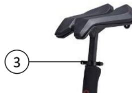
1. Libere la manija de acople rápido (3) tirando de la misma hacia afuera del tubo del chasis.
