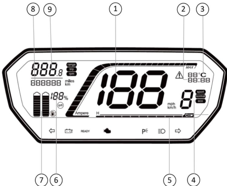
1. Velocímetro: Indica la velocidad actual en km/h o mph.
