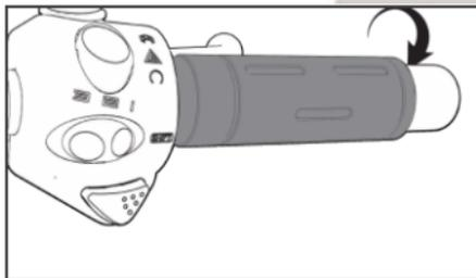
Se sugiere que después de acelerar usted gire nuevamente  $\frac{1}{4}$  de vuelta el acelerador devolviéndolo. Esto incrementará la autonomía y la vida útil de la batería.
