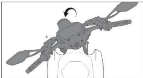
Inserte la llave en el bloqueo de la dirección suavemente y gire la llave a la posición LOCK en sentido horario.
