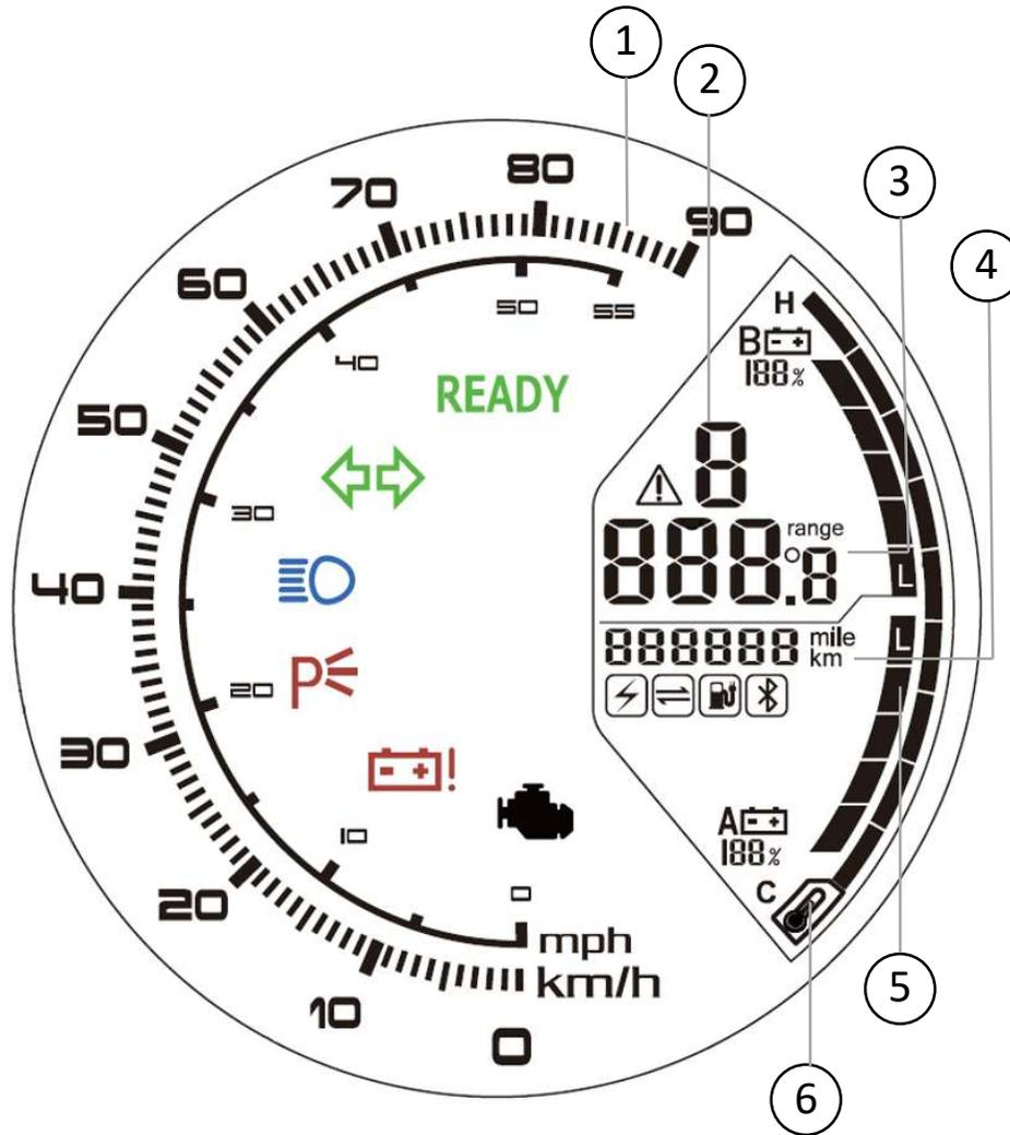
1. Velocímetro: Indica la velocidad actual en km/h o mph.
