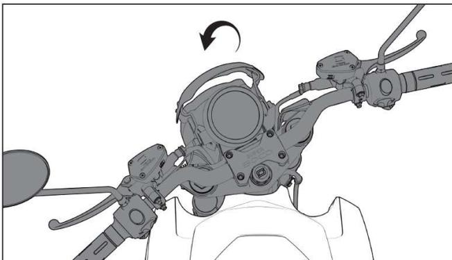
Inserte la llave en el bloqueo de la dirección suavemente y gire la llave a la posición LOCK en sentido horario.
