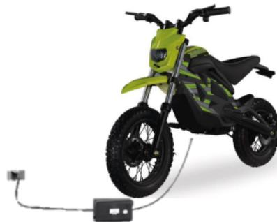
Todas las baterías se cargan de forma simultánea. Usted debe cargar su Producto si no se ha utilizado durante 15 días hasta que la luz led indicadora cambie a color verde; inmediatamente debe desconectar el cargador.
