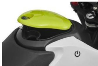
Para cerrarlo nuevamente posicione la tapa, procurando que el suiche quede en su posición original, inserte la llave en el suiche y presiónelo suavemente para que al girar la llave, el vástago del suiche entre en la ranura de bloqueo.
