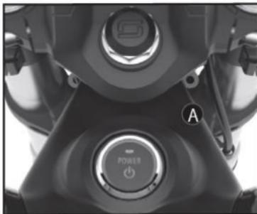
El botón principal de encendido (A) tiene como función encender o apagar el sistema eléctrico de su Vehículo. Una vez usted desbloquee el Vehículo con el control remoto oprima éste botón para encender el sistema eléctrico e iniciar la conducción.
