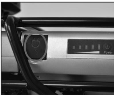
**- Paso 2:** A continuación, conecte el conector de entrada de energía del cargador a la toma de corriente (110 V / 60 Hz) una vez hecho esto la carga se iniciará.
