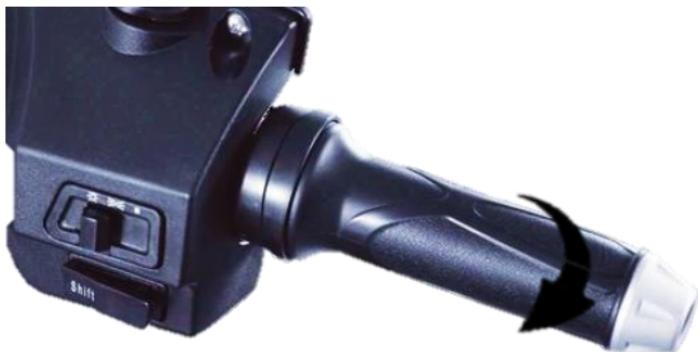
Se sugiere que después de acelerar usted gire nuevamente  $\frac{1}{4}$  de vuelta el acelerador devolviéndolo. Esto incrementará la autonomía y la vida útil de la batería.
