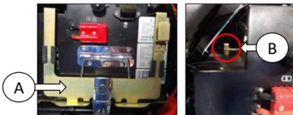
Soporte de la batería desmontado
