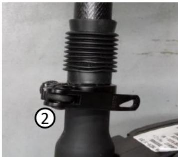
Libere la manija de acople rápido (2) tirando de la misma hacia afuera del tubo del chasis.
