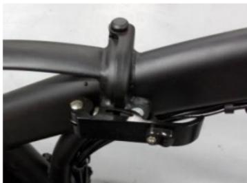
7. Tire de la manija del acople rápido y pliegue el chasis, dejando que este pliegue hacia el lado de la bisagra. Retenga el chasis para que no se vaya a golpear mientras este plegándolo.
