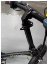
2. Abra el acople rápido de la abrazadera del sillín y gradúe la altura introduciendo el mismo hasta el límite mínimo. Cierre nuevamente el acople rápido asegurando el sillín.
