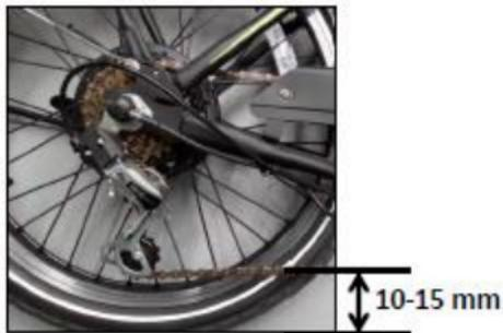
Verifique la tensión de la cadena, presionando la cadena hacia abajo, sin que el desviador se mueva. Esta no debe de moverse más de 10 a 15 milímetro (mm).
