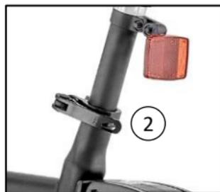
1. Libere la manija de acople rápido (2) tirando de la misma hacia afuera del tubo del chasis.
