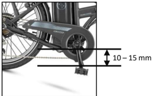
Verifique la tensión de la cadena, presionando la cadena hacia abajo, sin que el desviador se mueva. Esta no debe de moverse más de 10 a 15 milímetro (mm).
