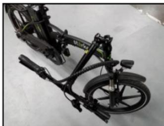
7. Tire de la manija del acople rápido y pliegue el chasis, dejando que este pliegue hacia el lado de la bisagra. Retenga el chasis para que no se vaya a golpear mientras este plegándolo.
