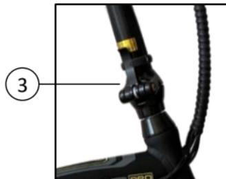
5. Tire de la manija del acople rápido hacia abajo y pliegue el tubo de la espiga, dejando que esta caiga hacia el lado de la bisagra. Retenga el manubrio para que no se vaya a golpear.
