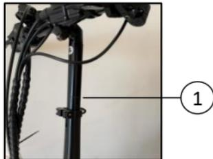
2. Abra el acople rápido de la abrazadera del sillín (2) y gradúe la altura introduciendo el mismo hasta el límite mínimo. Cierre nuevamente el acople rápido asegurando el sillín.
