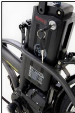
El Producto cuenta con una batería de Litio ion, sellada y libre de mantenimiento, la temperatura de operación debe estar entre -20°C a 60°C, la condición ideal es de 25°C. Si la temperatura es demasiado baja, esto puede reducir la capacidad efectiva de la batería para almacenar la energía.
