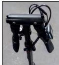
4. Ubique la palanca para plegado (C) en la parte inferior izquierda de su Producto. Usando el pie derecho písela hasta sentir que esta se mueve hacia abajo, posteriormente agarre el manubrio y presiónelo hacia adelante, con lo cual desbloqueará el sistema de plegado y la espiga se plegará. Retenga el manubrio para que no se
