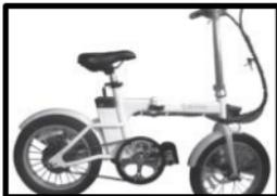
4. Tire de la manija del acople rápido para abrirla, posteriormente presione hacia arriba la manija de modo que se libere el pin de seguridad y pliegue el chasis, dejando que éste se pliegue hacia el lado de la bisagra. Retenga el chasis para que no se vaya a golpear mientras este plegándolo.
