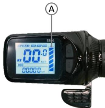
No agote la batería hasta su carga mínima permitida, cuando el indicador de carga del tablero y de la batería esté en el nivel mínimo de batería (barra inferior) cargue inmediatamente.
