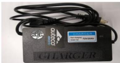
Su nuevo Vehículo eléctrico cuenta con un cargador externo, diseñado especialmente para cargar el pack de baterías de su Vehículo. El cargador cuenta con un indicador LED el cuál le indicará el estado del proceso de carga:
