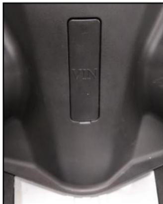
El número del VIN se encuentra ubicado en la parte inferior del cabezote, para verificarlo retire la tapa rectangular.
