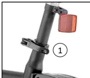
1. Libere la manija de acople rápido (1) tirando de la misma hacia afuera del tubo del chasis.
