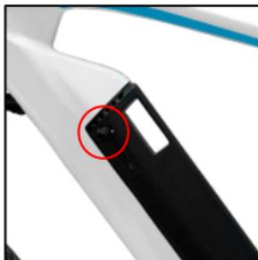
2. A continuación, conecte el enchufe de entrada de energía del cargador a la toma de corriente (110 V / 60 Hz), una vez hecho esto la carga se iniciará.
