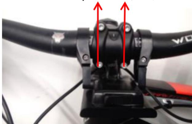
D. Ubicar el velocímetro de modo que el protector del puerto USB no quede atascado en ningún punto.
